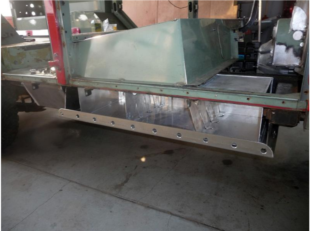
Der fertige Tank auf der Halterung von verschiedenen Seiten.
