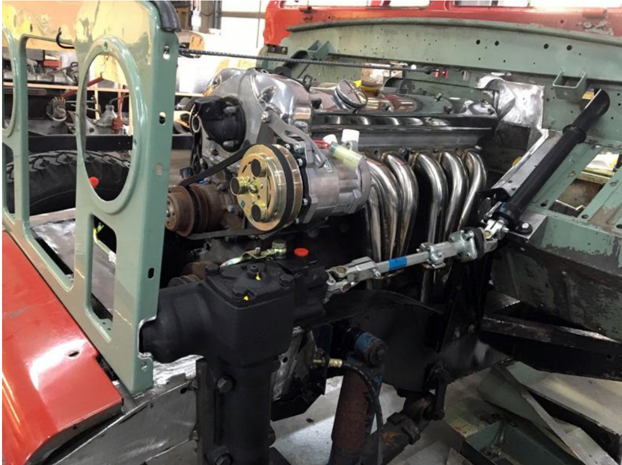
Hier wurde die Verstärkungsplatte an der das Lenkgetriebe festgeschraubt.
